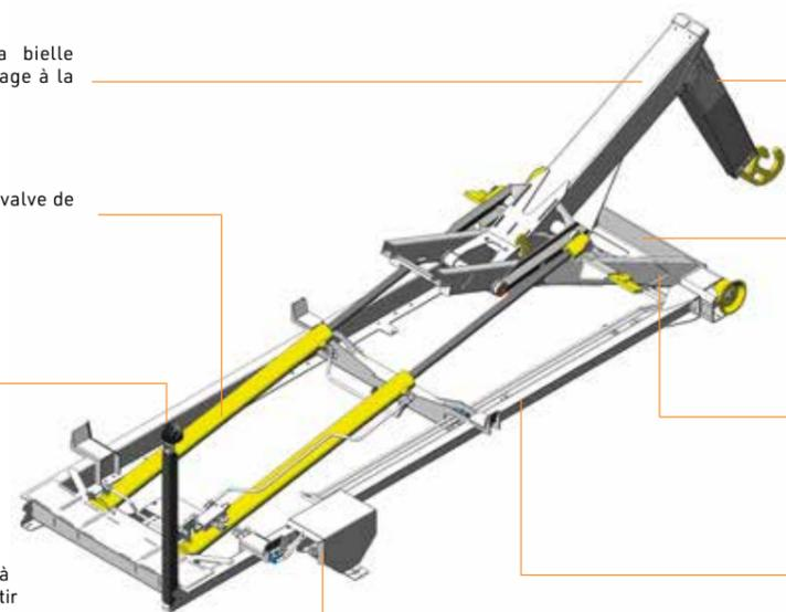
• **UNE POTENCE** coulissante actionnée par un vérin muni d'une valve de sécurité. Elle est munie d'un crochet de préhension démontable.
