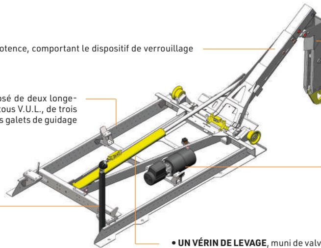
• **UNE POTENCE**, en deux parties, coulissante et articulée, afin de diminuer l'angle de préhension du caisson. Celle-ci est équipée d'un crochet de préhension démontable avec linguet de sécurité.
